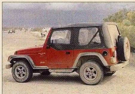
Die früheren seitlichen Ausstellfenster sind leider verschwunden; Seitenscheiben und Aussenspiegel werden manuell betätigt.
